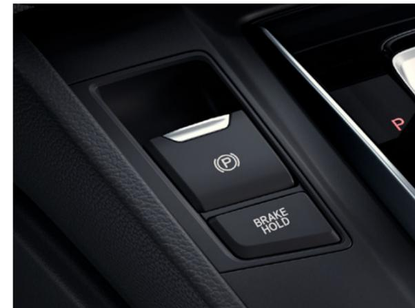
Freio de estacionamento eletrônico com função Brake Hold
